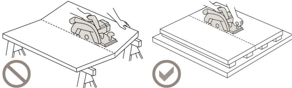
Fig. 45: Apoyo erróneo y apoyo correcto
