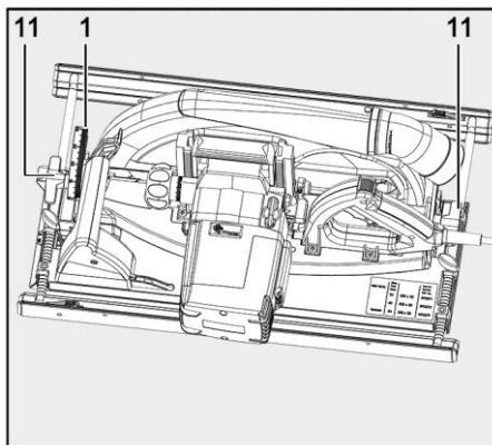
Fig. 57: Ajustar la sierra para cortes inclinados
