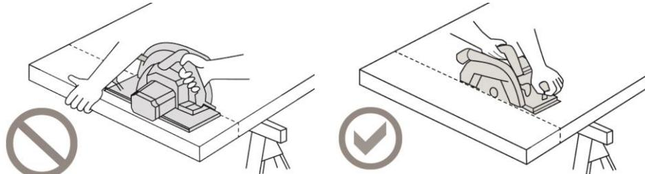
Fig. 43: Serrar erróneamente y serrar correctamente
