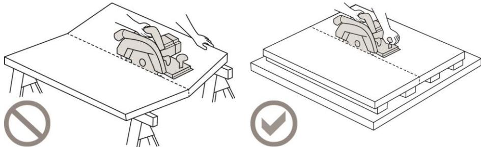
III. 25 : appui incorrect et correct
