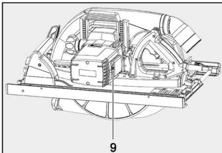
Fig. 54: Ajustar la velocidad con la rosca
