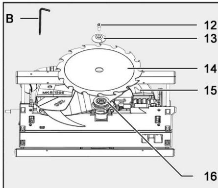
III. 31 : remplacement de la lame de scie
