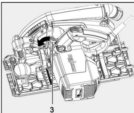
III. 37 : déverrouillage du levier de commande
