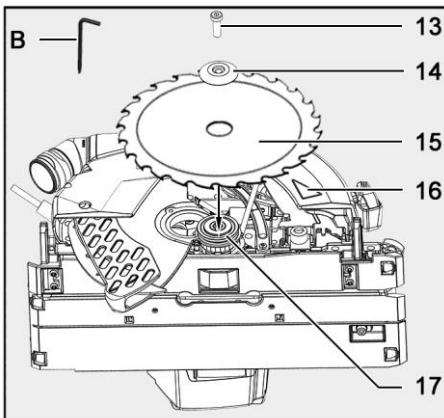
III. 36 : remplacement de la lame de scie
