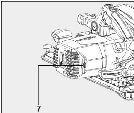
Fig. 67: Ajustar la velocidad con la rosca
