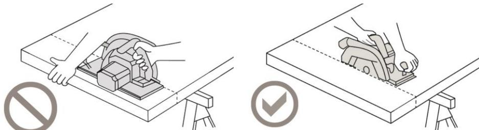
Fig. 55: Serrar erróneamente y serrar correctamente
