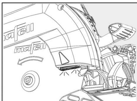
Fig. 66: Módulo de luz de la máquina
