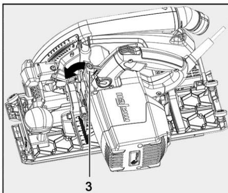
Fig. 63: Desbloquear la palanca de conmutación
