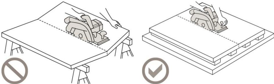
III. 31 : appui incorrect et correct
