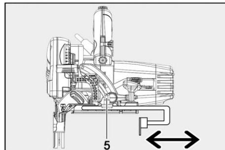
III. 52 : réglage de la largeur de coupe à l'aide du rouleau-guide
