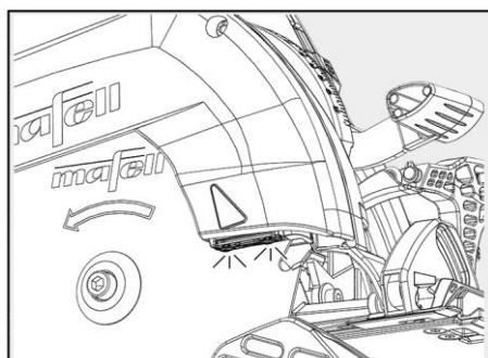
III. 40 : module d'éclairage sur la machine
