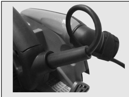
Fig. 56: Montaje del cable de conexión
